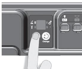
Appuyez sur le bouton Select pour modifier le réglage du disjoncteur. Le menu apparaît sur l'afficheur. L'afficheur in.scan affiche «x P», le «x» représente le nombre de phases utilisées par le réseau d'alimentation.
